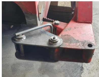
REFECTION D'UN BRAS CHARIOT DE ELEVTEUR
