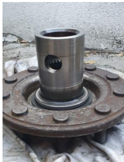
RECHARGEMENT ET REMISE AUX COTES D'UN MOYEUX
